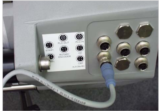
[6] Sensor connections on the ALS 20x (RH)
