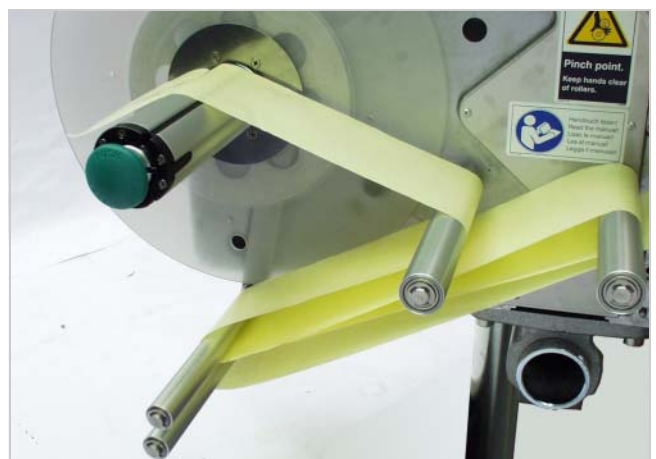
[45] Trägerpapier um Tänzerarm und Umlenkrollen führen.
