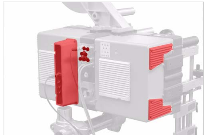
[17] Staub-/Spritzwasserschutz (rot bzw. dunkel abgebildet)
